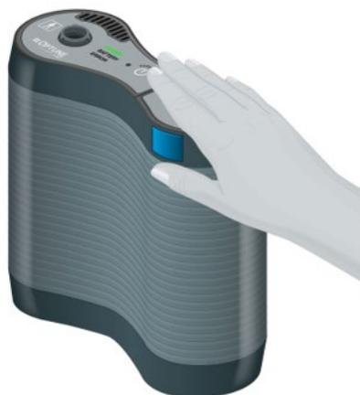
Nehmen Sie den Akku aus dem Steckplatz, indem Sie auf beide blauen Tasten an den Seiten des Akkus drücken und dann den Akku herausziehen.
