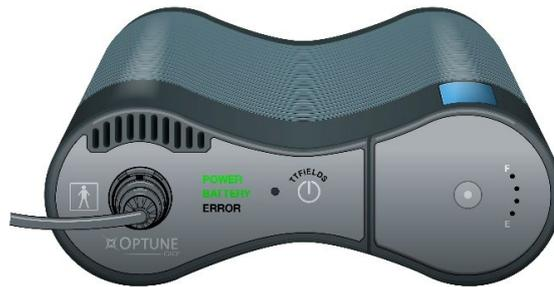
Wenn ein an das Stromnetz angeschlossenes Netzteil an das Gerät angeschlossen ist, wird das Gerät über dieses Netzteil mit Strom versorgt und die „BATTERY“ (Akku)-Anzeige leuchtet nicht auf.
