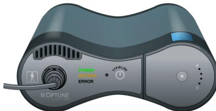
Wenn Ihr Akku leer wird (nach ca. 2-3 Stunden), ertönt das Warnsignal und die TFields-Behandlung wird abgeschaltet. Wenn das der Fall ist, wechselt die „BATTERY“ (Akku)-Anzeige auf gelb und die rote ERROR (Fehler)-Anzeige leuchtet auf. Dieses Warnsignal ist derselbe Ton, den das Gerät bei einem Fehler auslöst. Jedoch leuchten in diesem Fall sowohl die gelbe BATTERY (Akku)-Anzeige als auch die rote ERROR (Fehler)-Anzeige auf und nicht nur das rote Licht.
